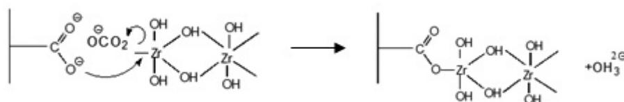
Obr. 1: Interakcia uhličitanu zirkoničito amónneho s karboxylovými funkčnými skupinami organických polymérov
