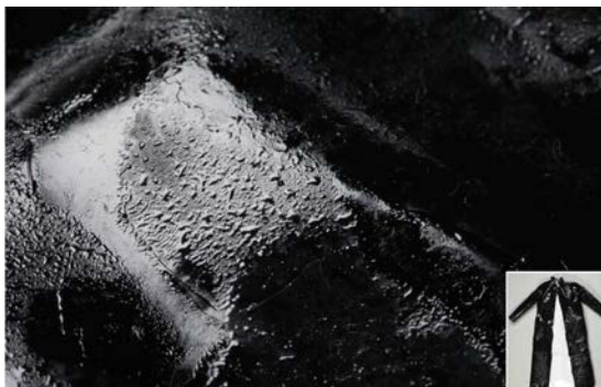
Obr. 4: Pršiplášť z PVC-P (1978) – lepkavá vrstva zmäkčovadiel na povrchu (Damage, 2012)
