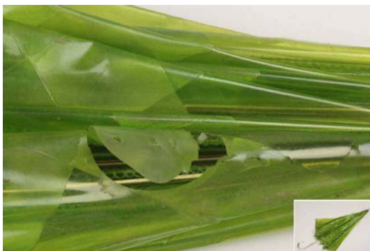
Obr. 5: Dáždnik z PVC-P (1979) – krehnutie (Damage, 2012)
