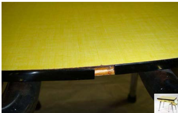
Obr. 6: Čierny okraj stola z PVC-P (1960) – zmršťovanie (Damage, 2012)
